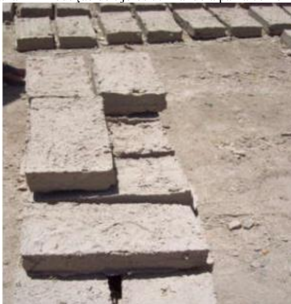
Figura 2 – Produção de tijolos utilizando a palha como fibra.
