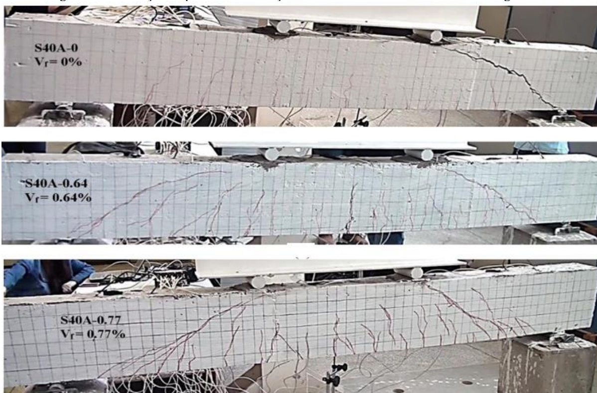
Figura 25 – Alteração do padrão de fissuração com o aumento do teor de fibras nas vigas S40.
