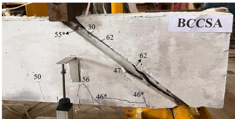
c) Carga na 1ª fissura de cisalhamento: 0,44 \cdot P_u \approx 30 \text{ kN} ( P_u = 67,6 \text{ kN} ).
