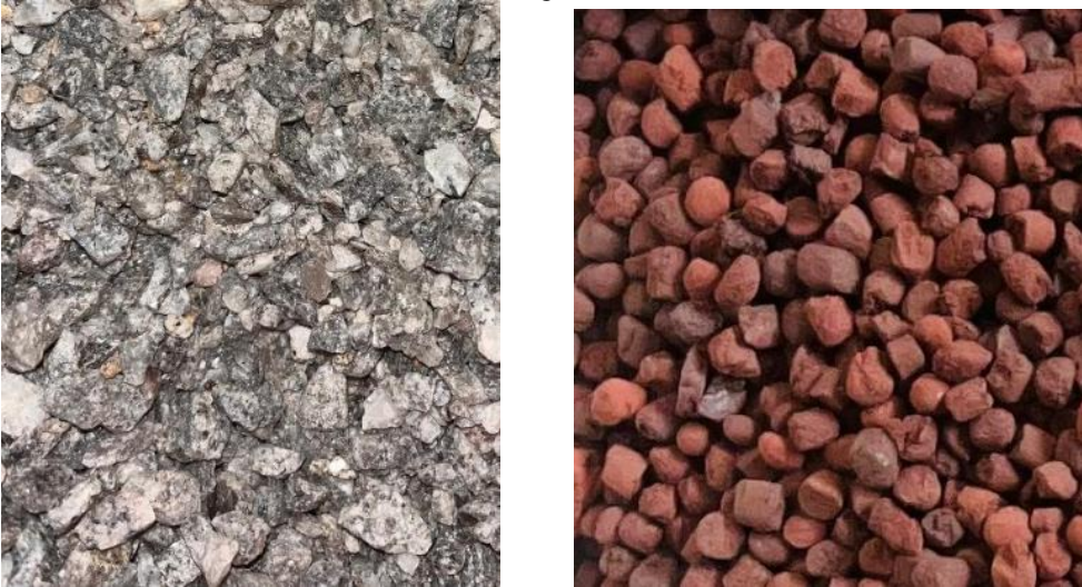
Figura 48 – Amostra do agregado graúdo natural e sintético.
