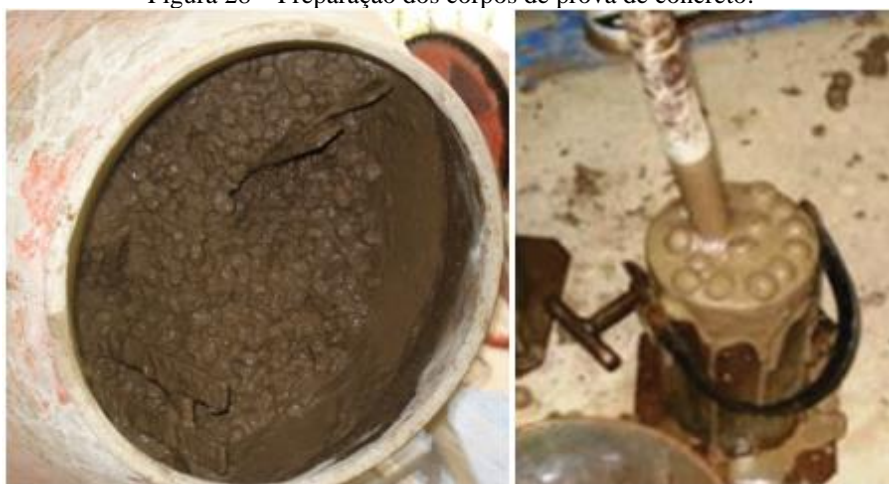
Figura 28 – Preparação dos corpos de prova de concreto.
