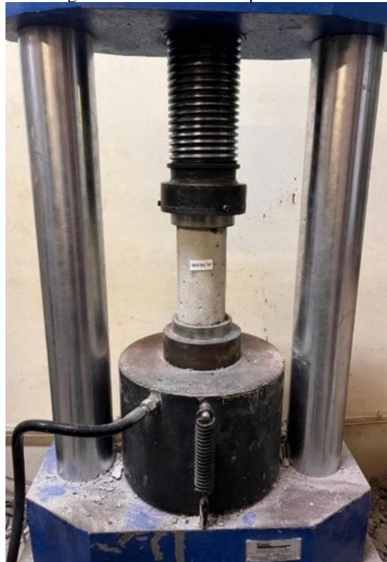
Figura 59 – Ensaio de compressão axial.
