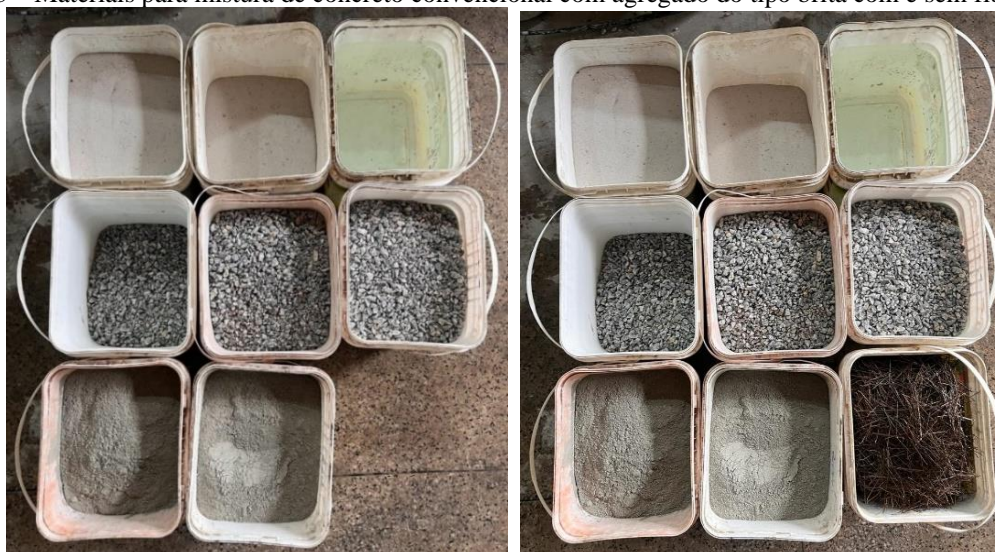
Figura 53 – Materiais para mistura de concreto convencional com agregado do tipo brita com e sem fibra de aço.
