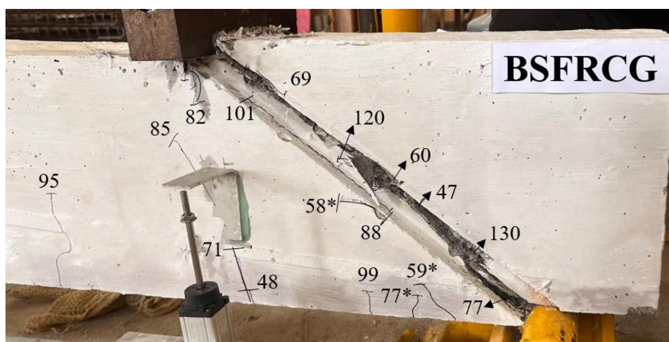
e) Carga na 1ª fissura de cisalhamento: 0,36 \cdot P_u \approx 47 \text{ kN} ( P_u = 130,1 \text{ kN} ).
