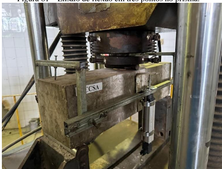
Figura 61 – Ensaio de flexão em três pontos no prisma.
