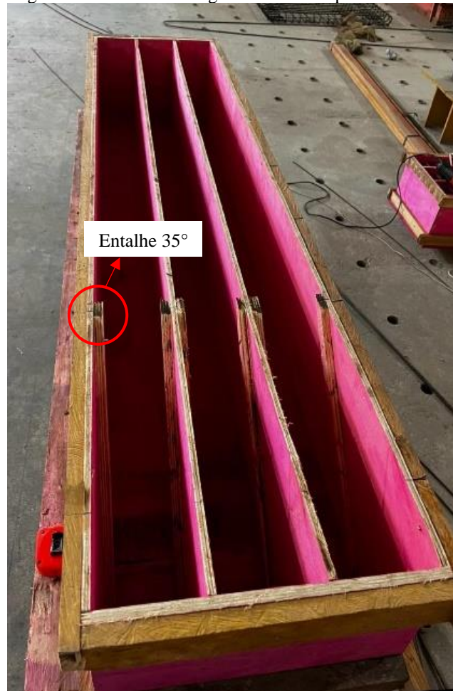
Figura 37 – Forma das vigas com entalhe pré definido.
