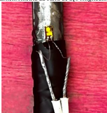
Figura 45 – Extensometria da barra de aço longitudinal (12,5 mm).
