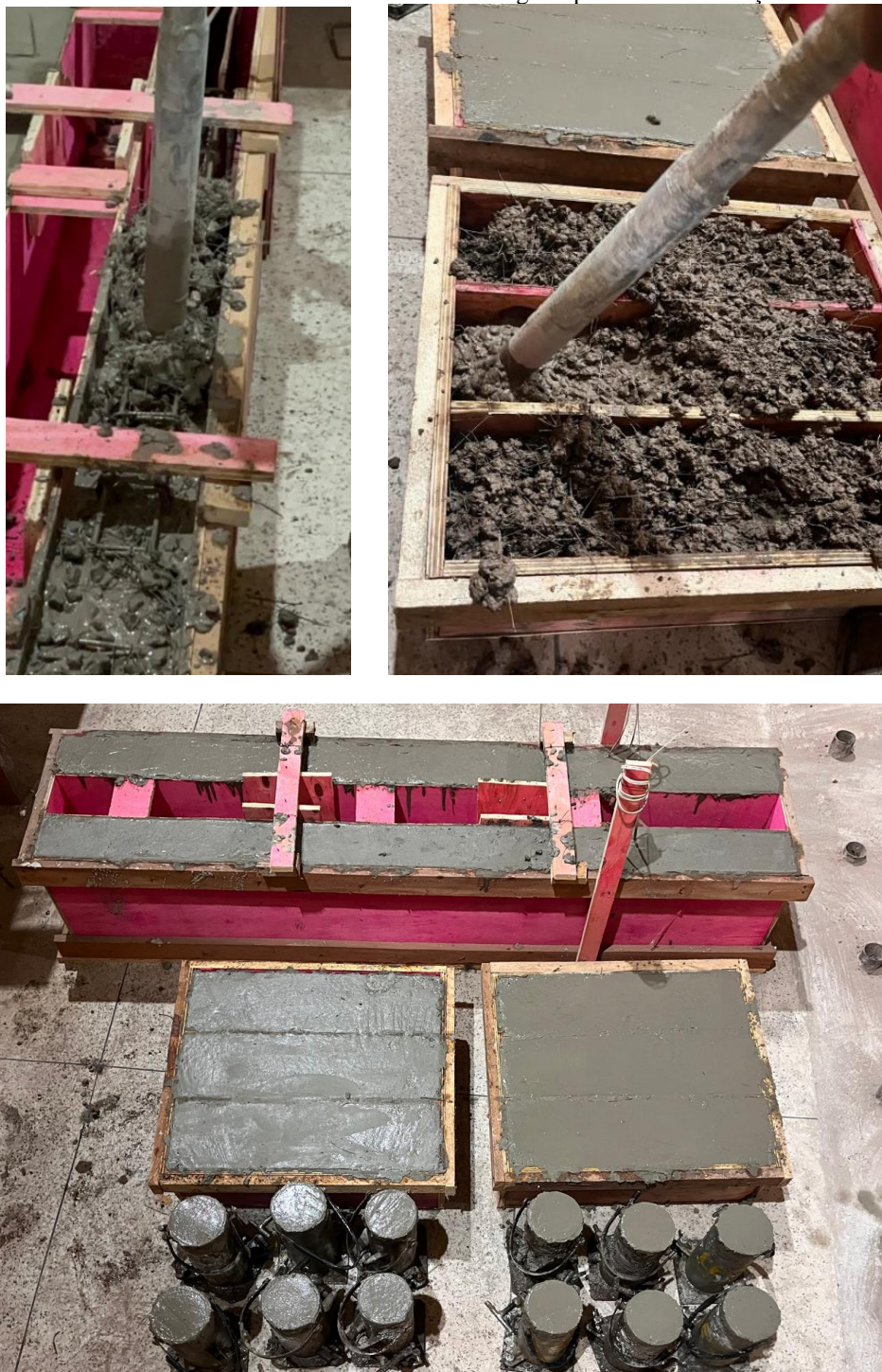
Figura 55 – Adensamento com auxílio do vibrador nas vigas e prismas e finalização da concretagem.
