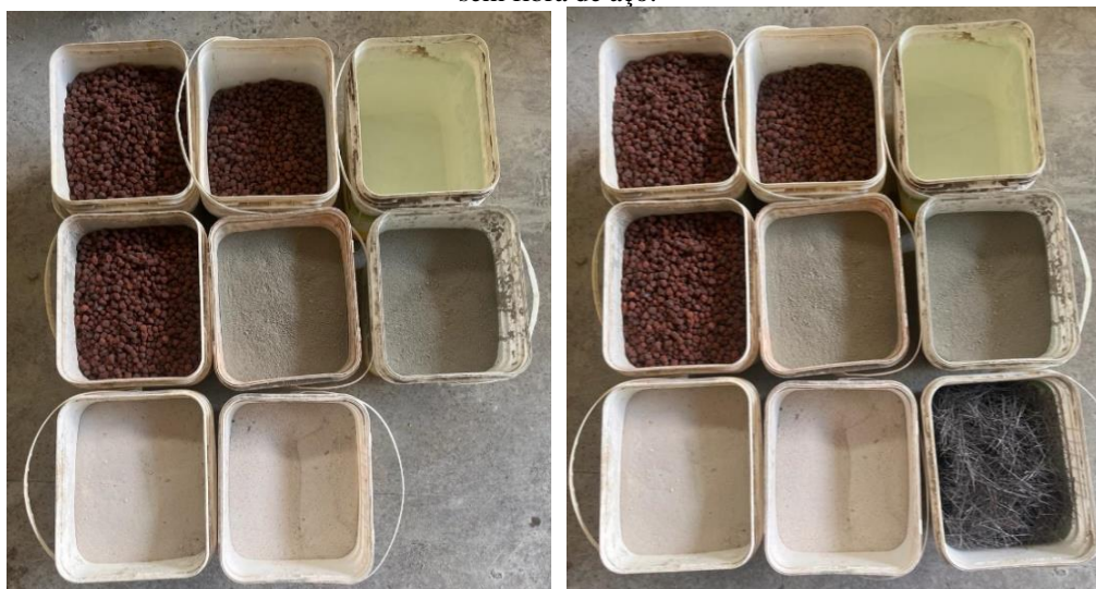
Figura 54 – Materiais para mistura de concreto convencional com agregado sintético de resíduo de bauxita com e sem fibra de aço.
