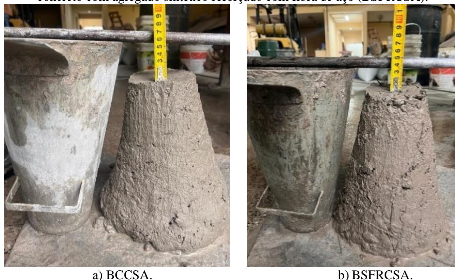
Figura 58 – Ensaio de abatimento de tronco do concreto convencional com agregado sintético (BCCSA) e do concreto com agregado sintético reforçado com fibra de aço (BSFRCSA).
