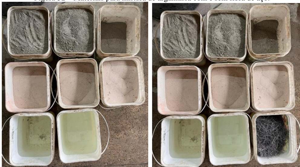
Figura 52 – Materiais para mistura de argamassa com e sem fibra de aço.
