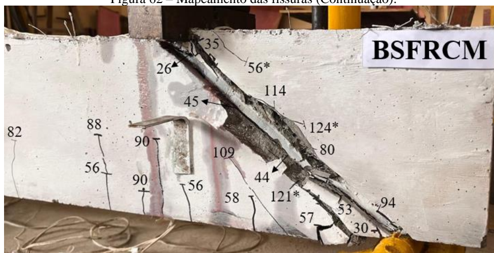
d) Carga na 1ª fissura de cisalhamento: 0,21 \cdot P_u \approx 26 \text{ kN} ( P_u = 125,8 \text{ kN} ).
